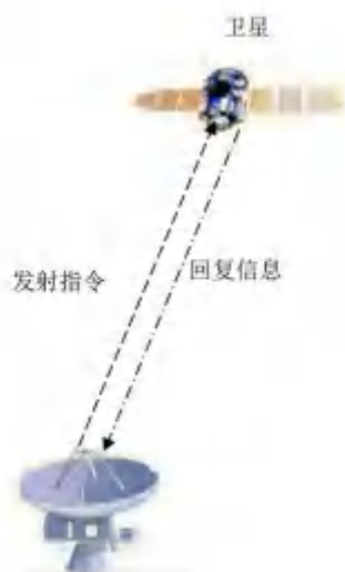
图 2.3-1 卫星地球站工作原理图
